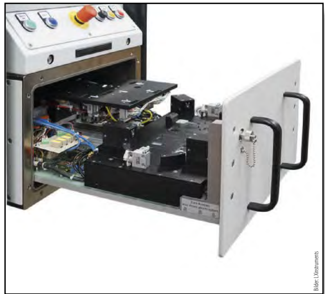
Individueller Ausbau mit Prüfaufnahmen und Messtechnik: Die in Baugruppen zunehmend verbreiteten Funkschnittstellen erfordern in einer industriellen Fertigungsumgebung eine HF-geschirmte Testzelle mit Koppelantenne.
