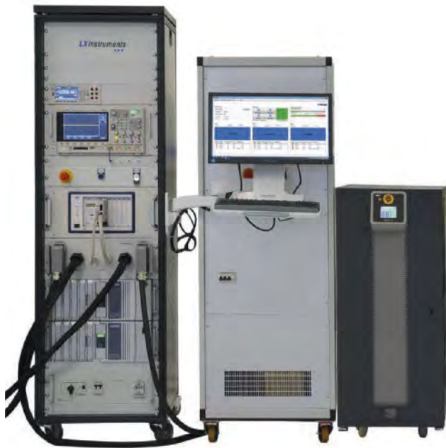
System zur Leistungs- und Kommunikationsprüfung: Die Fahrzeugkommunikation via PWM und Widerstandskodierung lässt sich im Leistungstest ebenfalls vom Testsystem übernehmen, um die unterschiedlichen Betriebszustände der ICCB zu verifizieren.
