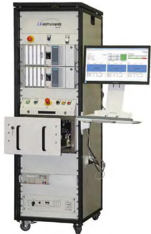
All-in-One: Prüfung der Steuerelektronik, Funktionsschnittstellen und des Displays in einer geschirmten HF-Schublade. Im unteren Bereich ist eine Prüfaufnahme mit Nadeln und im oberen Bereich die Kamera mit Touchfinger-Mechanik sowie die Koppelantennen integriert.
