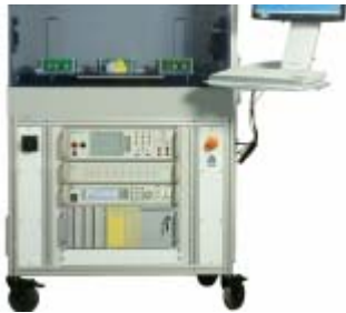
Bild 2: Alle Funktionen der elektrischen Sicherheitsprüfung mit zusätzlichen AC-Stromquellen und Sicherheitsaufnahme wird in einem Rollwagen an das Funktionstestsystem angedockt und benutzt alle Ressourcen mit. (Bild: LXinstruments)
