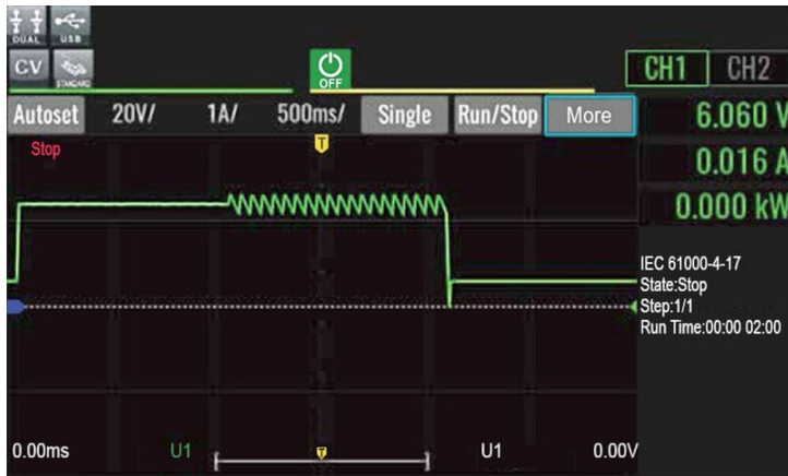
Bild 2: Kurvenverlauf bei Störfestigkeitsprüfungen nach IEC 61000-4-17.
